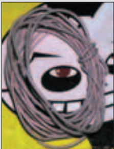
Рис. 17. Провод во фторопластовой изоляции
